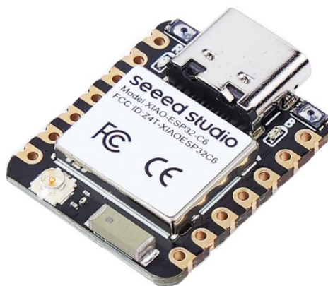
Rysunek 11. Mikrokontroler Seeed Studio XIAO ESP32C6 (źródło: [47]).
