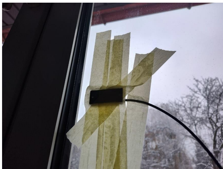
Rysunek 3. Czujnik natężenia światła przymocowany do szyby
