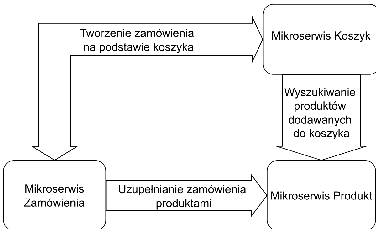
Rysunek 9. Diagram wymaganej struktury oraz opis komunikacji między mikroserwisami – źródło: opracowanie własne
