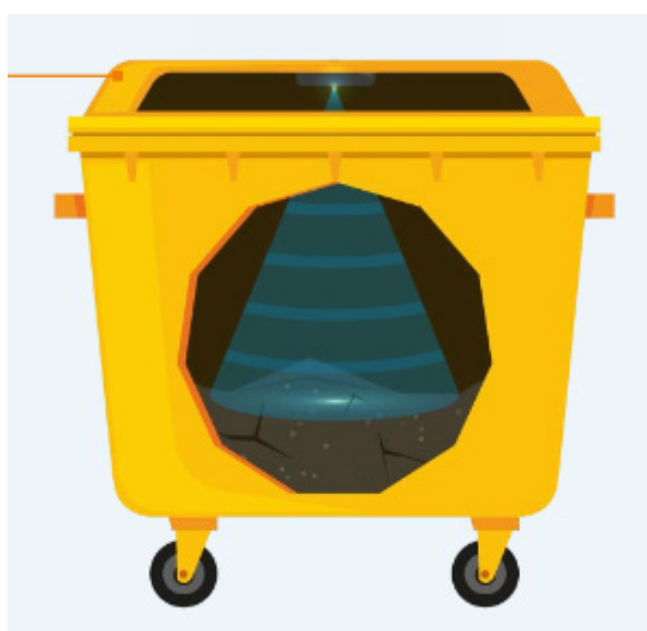
Rysunek 13. Montaż urządzenia Bin Box w kontenerze. Źródło: [13]
