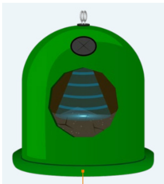
Rysunek 12. Montaż urządzenia Bin Box w pojemniku typu dzwon. Źródło: [13]
